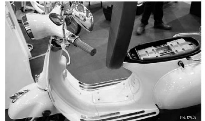
Piffige Idee: Elektroroller für die Stadt: Ist die Batterie leer wird sie an der nächsten Ladestation einfach ausgetauscht.
