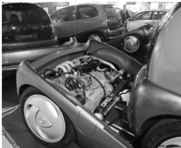
Das Verbrennungsmotormodul des Opel Twin mit Motor, Getriebe, Achse und Tank.
