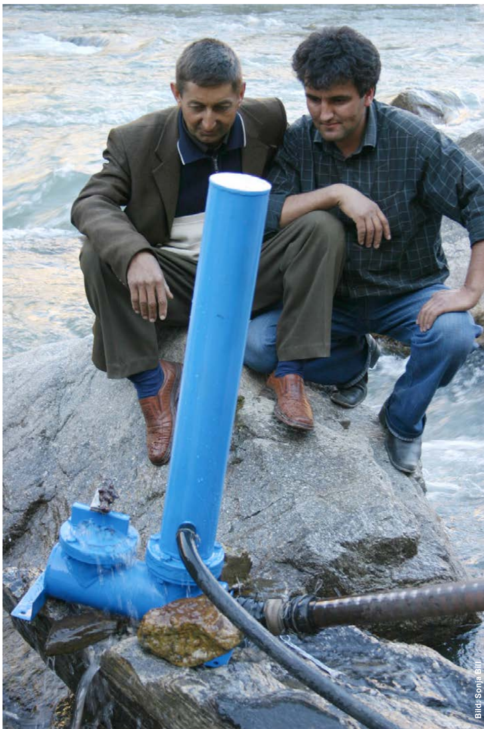
Drei Tage in der Metallwerkstatt und ein wenig sowjetisch-blaue Farbe – fertig ist der „Wasser-Widder“.
