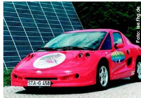
Automobil mit Brennstoffzellen-Antrieb. Der Wasserstoff wird komplett regenerativ erzeugt. Im Hintergrund die Photovoltaik-Anlage zur Stromerzeugung für die Elektrolyse.
