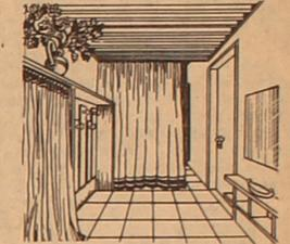
Die Seite des Korridors, auf der sich Wandvertiefungen befinden, wird in etwa 160 cm Höhe durch ein Brett horizontal getrennt. Vertikal erhält es Stützen an den beiden Enden und etwa in der Mitte.
