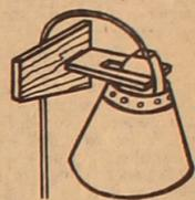
Der Zapfen der Konsole ist relativ kurz gehalten, deshalb sichern wir ihn gegen ein Herausziehen an der hinteren Fläche noch durch Keile (Spaltwirkung beachten!). Er wird auch einer starken Biegebeanspruchung ausgesetzt.
