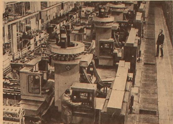
Im Werkzeugmaschinenbetrieb „Zalgiris“ von Vilnius erfolgt die Funktionskontrolle des Programms eines flexiblen Fertigungssystems, bestimmt für die automatisierte Bearbeitung der Gehäuseteile von Zerspanungsmaschinen.
