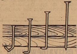
Um das Zerplatzen kleiner Holzleiten beim Nageln zu verhindern, wird die Nagelspitze gestaut. Die gestaute Spitze zerlegt das Holz, und der Nagel treibt das Holz dadurch nicht auseinander.
