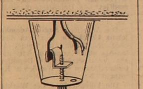
sich z. B. ein Trinkbecher aus Plast, in den entsprechende Löcher für einen Befestigungsbolzen und die abgehende Leitung gesteckt werden. Der Bolzen wird in eine Schelle geschraubt, die an dem Deckenhaken hängt. Abdeckhauben gibt es auch im Handel.
