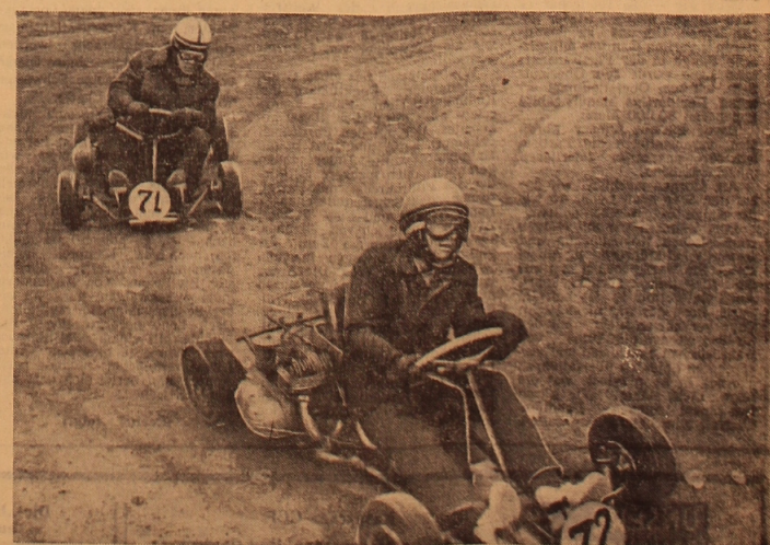
Seit 3 Jahren funktioniert in der 11. Schule in Ust-Kamenogorsk eine Sektion für Kartingfahrer. Zusammen mit dem Werklehrer Konstantin Weber konstruierten die Schüler den Wagenrahmen, montierten von einem Motorrad den Motor hinein. Aus den Reifenfabriken wurden sie von den Arbeitern mit Rädern versorgt. Gegenwärtig besitzen die Schüler 6 Kartingwagen, zweimal wöchentlich trainieren sie im Stadion. Im vorigen Jahr beteiligten sie sich am Republik-Wettbewerb der Schüler und belegten den 7. Platz. UNSERE BILDER: 1. Der junge Rennfahrer Woldemar Weber vor dem Start. 2. Witja Balow und Nurachmet Amanow auf der Rennbahn. Fotos: W. Pawlunin
