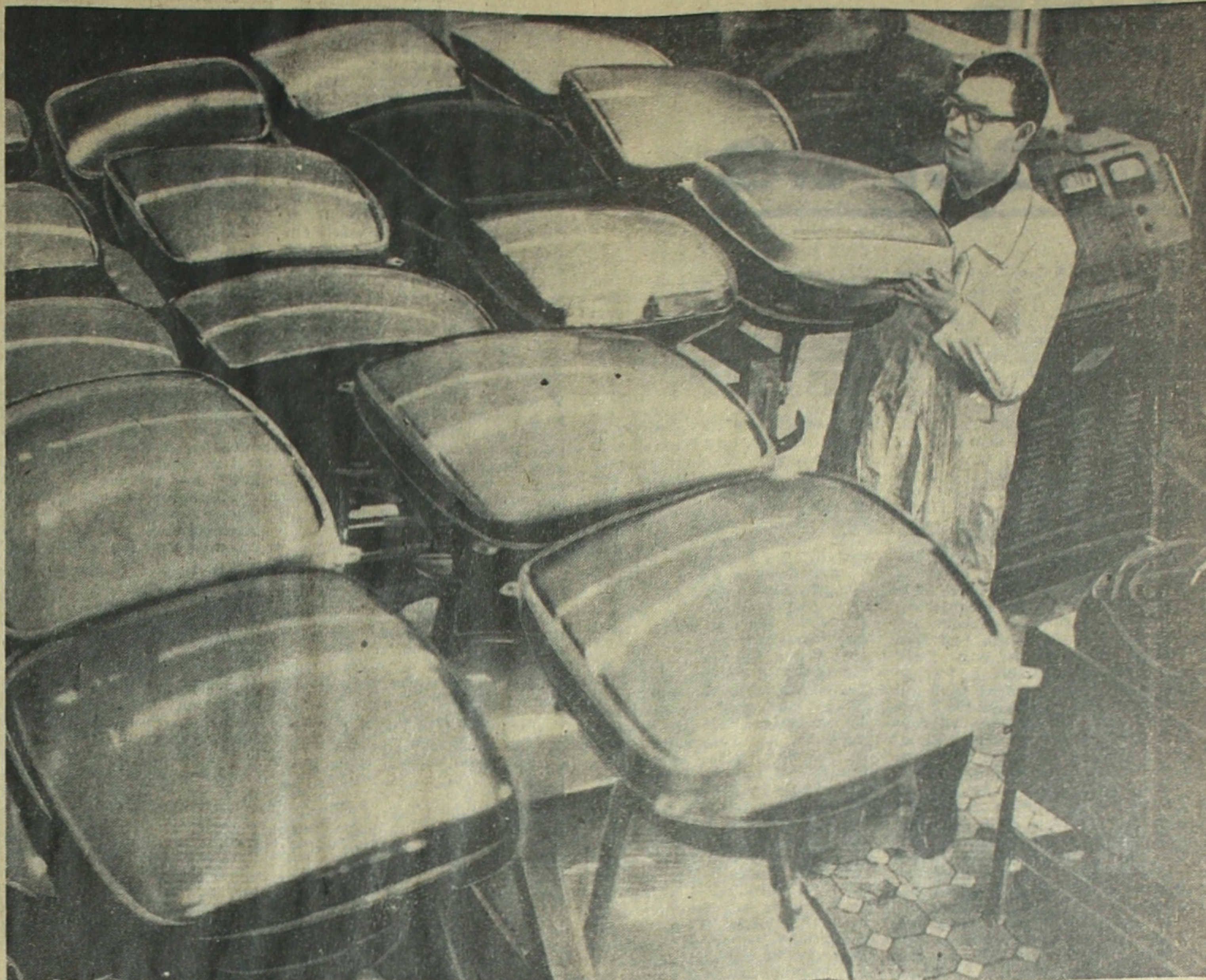
Die Ingenieure des Moskauer Elektrovakuumschulens schufen eine neue Bildröhre für das Farbfernsehen mit einer Schirmdiagonale von 65 Zentimetern. Jetzt wird die neue Bildröhre erfolgreich im Laboratorium erprobt. UNSER BILD: Ingenieur Michail Stepanow untersucht die Labormodelle der neuen Bildröhre für das Farbfernsehen. Foto: R. Altimow (APN)
